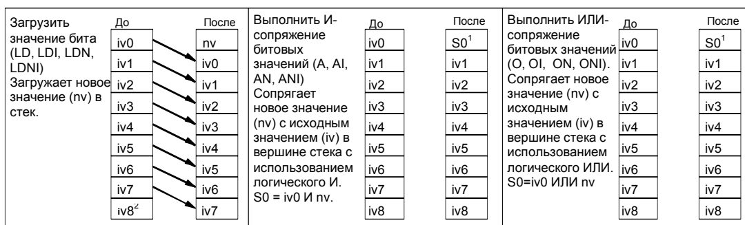
Рис. 6-2. Принцип действия контактов.
